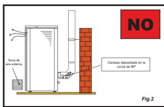
Es posible aprovechar un tubo de humos o un canal mediante un conducto. Para este tipo de instalación es necesario respetar las normas relativas a los sistemas de evacuación de humo en conductos. En la parte inferior del tubo de humos ubicado dentro de la casa se ha instalado un conector tipo "T" con tapa de inspección; en el exterior se ha instalado otro, para que el tramo externo se pueda inspeccionar.
