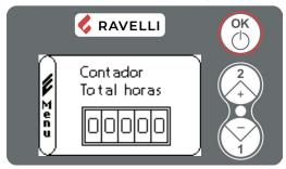
Se accede a la visualización de las horas de trabajo de la estufa. Para ver los diferentes contadores (horas totales, horas parciales y numeros de encendidos) utilizar los botones 1 y 2.
