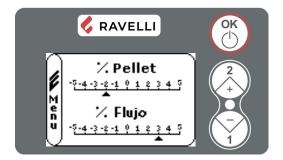
Se accede a la regulación de la mezcla aire/pellet. Para modificar el porcentaje utilizar los botones 1 y 2, para pasar de la regulación de la cantidad de pellet a la regulación del flujo de aire en ingreso pulsar OK.
