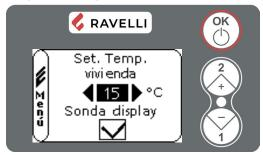
Configure la temperatura deseada con las teclas 1 y 2. Los valores seleccionables son: EXT, de 7 °C a 40 °C, MAN. Hay que seleccionar el valor EXT si se desea utilizar el termostato externo y MAN cuando se desea que la estufa funcione a potencia constante. Para regresar directamente a la pantalla «Inicio», presione las teclas 1 y 2 al mismo tiempo, o bien, presione OK para pasar a «Sonda display».
