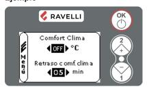
Para activar el Confort Clima, programar un valor diferente de OFF utilizando los botones 1 y 2. Confirmar por OK.
