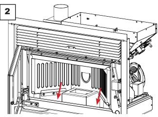
Aspire los residuos presentes en la bandeja para cenizas con un aspirador de cenizas específico, asegurándose de que las cenizas estén completamente apagadas.
