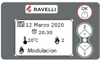
Se activa la fase de modulación, porque se ha alcanzado la temperatura del set ambiente. Si la temperatura es mantenida para todo el tiempo del "RETRASO COMFORT CLIMA" programado la estufa se apaga.
